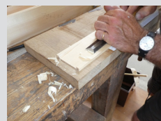
Façonnage d'un biseau
